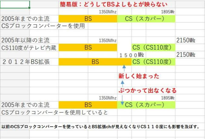
図2ブロックコンバーター出力の周波数重なりイメージ
